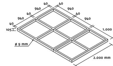
Zwei nebeneinanderliegende Deckenrahmen 2 m × 2 m und 1 m × 2 m mit jew. oben querliegender Stromschiene.
